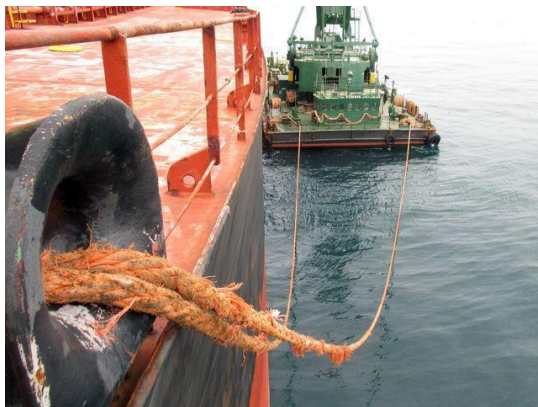
Cabos de amarre desgastados
