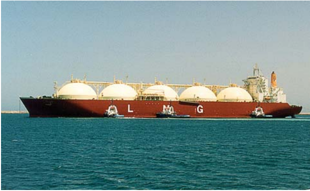
LNG carrier with Type-B tanks (Kvaerner Moss system)
