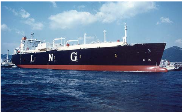
LNG carrier with membrane tanks
