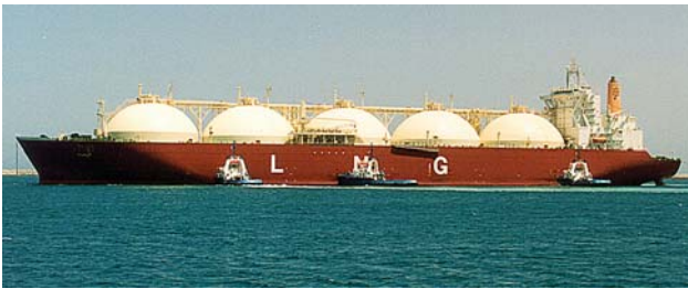
LNG carrier with Type-B tanks (Kvaerner Moss system)
