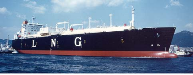
LNG carrier with membrane tanks
