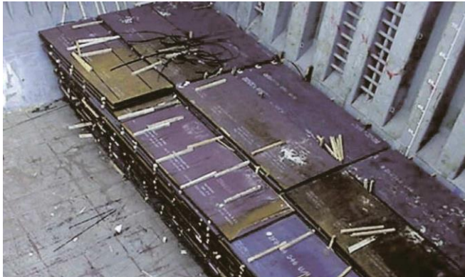
図表 12.14: 鋼板の正しい積み付け
