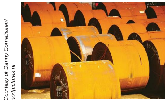
図表 12.5: コイルの外面に発生した錆
