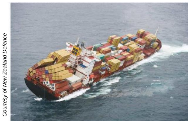
図 41.1: 2011 年ニュージーランド沖で発生した「 Rena 」号の座礁事故では、多くのコンテナツイストロックに過大な応力がかかり、積載コンテナの一部が崩壊した
