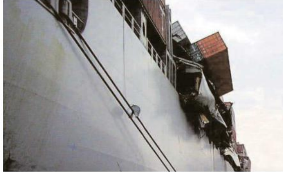
図 41.14: 不適切な積付の結果、倒壊したコンテナ・スタック
