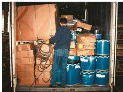
図 41.3: 不適切に積み込まれたコンテナ 破損した荷物、カートンの上に置かれたパレット、明らかな固縛の欠如に注意
