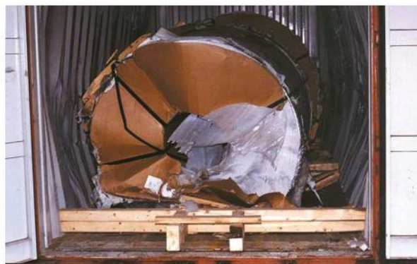
図 41.5: 面縛が不十分なコイルによってコンテナに生じた損害
