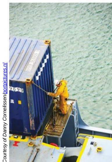
図 41.26: コンテナをラッシング・ブリッジに固縛する
