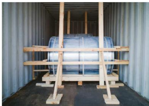
図 54.2: コンテナ内で貨物を固定する際のベストプラクティスの例。
