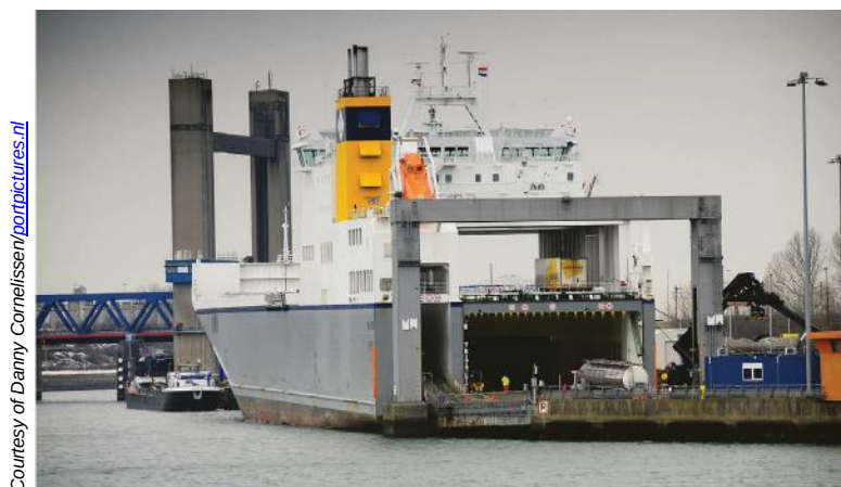
図 54.1: RORO 船の実際の船倉スペースより上の多くの場所は、風や海からの猛攻撃に完全には晒されていないでも「甲板上」と考えるのが妥当である。
