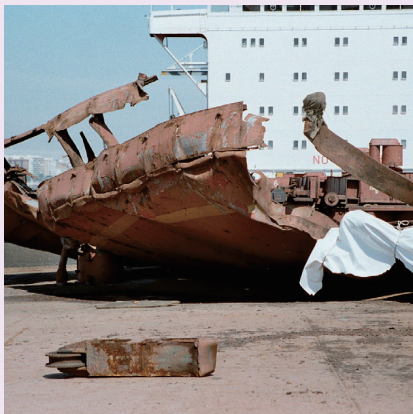
图为直接还原铁爆炸导致的损毁 (感谢Burgoynes提供图片)
