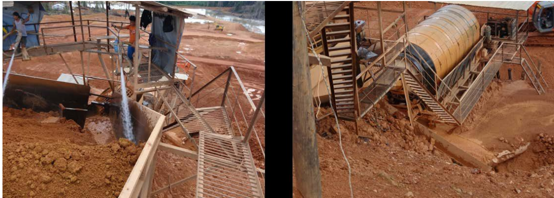
Fotografías que muestran operación de tamizado en una Mina de Bauxita en Kalimantan, Indonesia.
