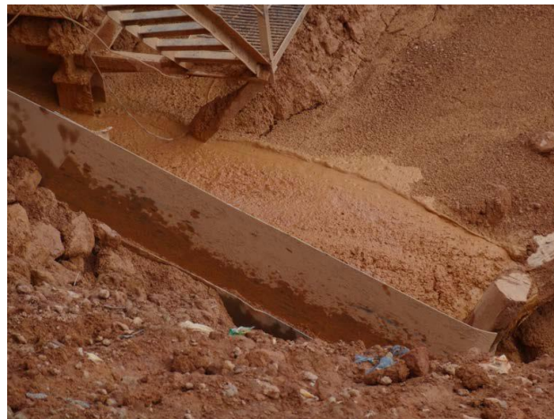
Primer plano que muestra lodo de mineral de bauxita bajo el tamiz rotativo.
