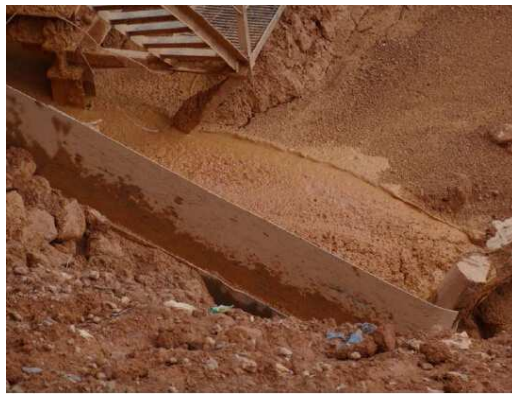
图为回转筛底下的铝土矿粘土近景
