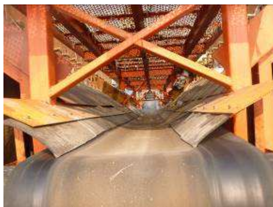
化肥通過鐵篩網漏入皮帶機
