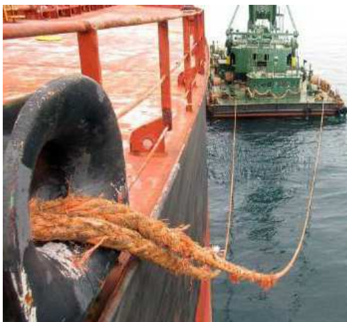
纜繩受損嚴重
