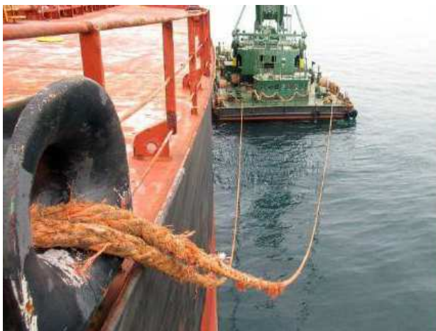
缆绳受损严重
