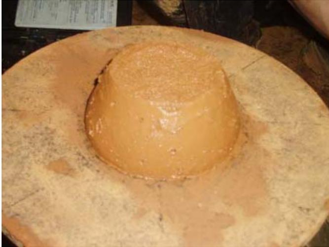
(图 2: 测试后样品圆锥体形状的变化, 锥体直径增大 6.5 毫米)
