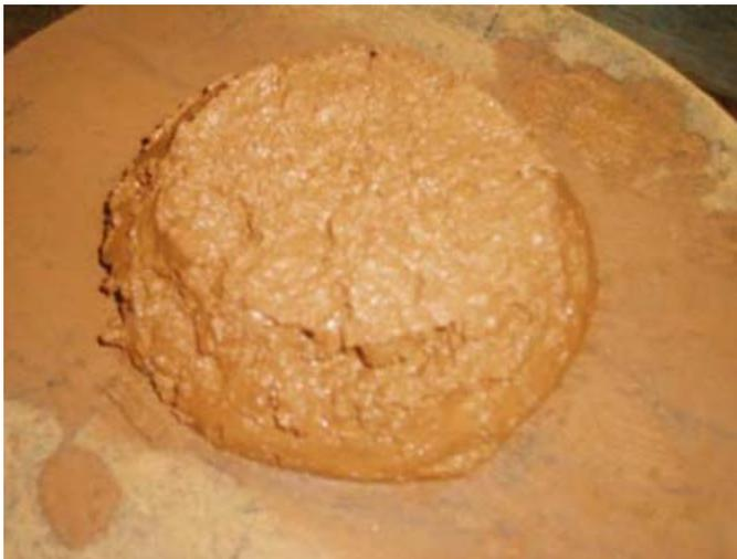
(图 3: 测试后的样品圆锥体, 底部增大了 20 毫米)
