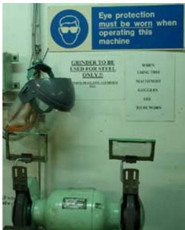
机舱工作室通常配备了立柱磨床和台式磨床。UK 保赔协会的船舶检验师有时会发现船上的研磨机没有配备安全保护罩。未完全了解研磨机磨盘破碎风险的船员有时会将保护罩拆除，或不用。一个正确装配的护罩在研磨机在工作过程中发生破碎时可以阻挡碎屑伤到使用者。
