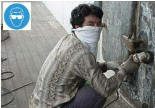
本图片显示了一名船员在未戴护目镜的情况下操作一台手动研磨机。
