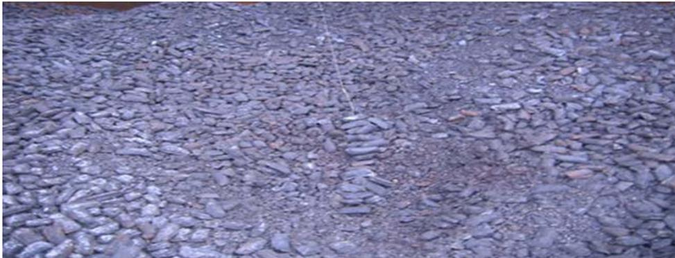
附上的图片展示了本案中铁块的破碎程度，特别是出现了大量的微细颗粒。这些微细颗粒提供了更多的氧化面积与货舱气体中存在的任何水分或湿气会发生反应。在海上环境中，任何水分或湿气都含有盐份，这会加快氧化程度和产生氢气的速度。
