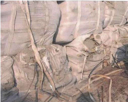
运输水泥可能会存在各种问题。当船舶驶经好望角时，存放在其它货物下面的水泥常常因没有恰当保护或包装在恶劣天气下遭受损坏。水泥还可能因为货舱进水而结块。罗安达港码头工人处理货物不当也是在该港发生货损的主要原因之一；其后果会导致水泥袋破损，货物散落在货舱里。由于吊机和机械管理不当，问题时有发生，如水泥袋掉落，可能会非常危险，还可能会导致货物在船边落水。另外，罗安达港的偷窃是个值得注意的问题，希望各会员保持警惕。
