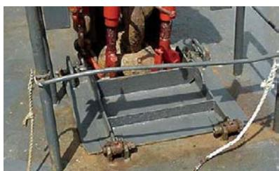
因为毒品必须得搬运到船上，所以进入船舶的方式是首要关注的因素。某些区域常常被忽略，如船艏艤的锚链筒，由于锚在入港前可能就已被清理，该区域就变成无人看管的开放区域了。正如所述，船舶应对锚链筒采取保护措施，以防船上“不速之客”。船舶对通向锚链舱的锚链管也应采取保护措施，因为，不论对于人还是货物，锚链舱都可能是个很方便的藏身之处。
