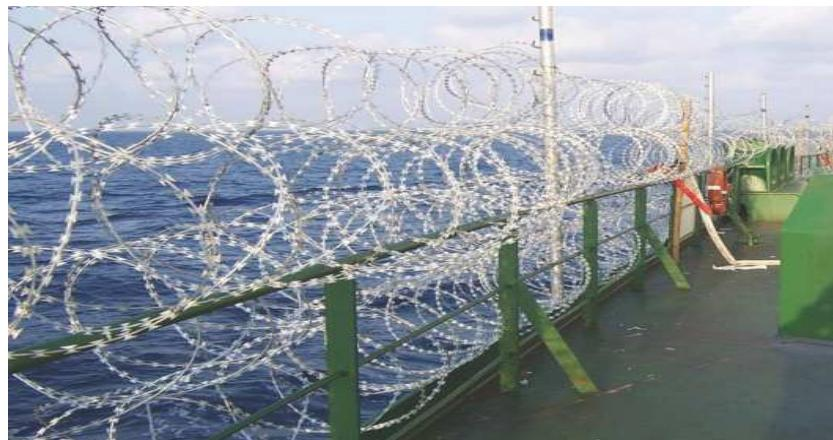
建議使用伸縮鐵絲網，因為相互連接的螺旋可以構成最有效的障礙。刺刀蛇籠應使用高強度鋼絲製造，方難以使用手工器具切斷。建議使用的籠圈直徑為 730 公釐或 980 公釐的伸縮鐵絲網。
