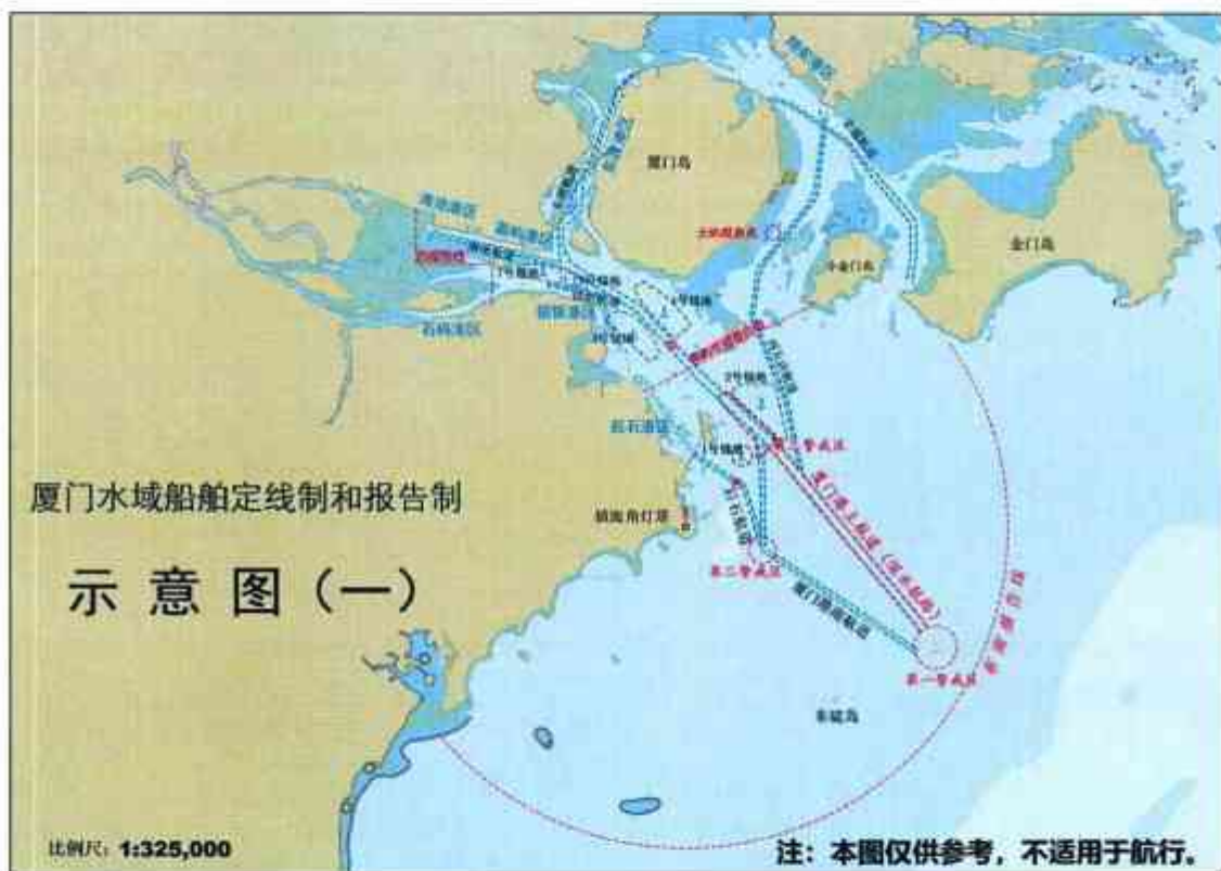
厦门水域船舶定线制示意图（一）
